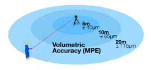
\*Measurement of a ScaleBar per ASME B89.4.19-2006
